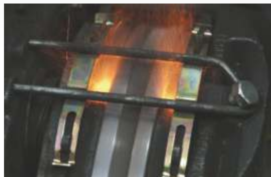
Disque de frein soumis à un essai de fatigue thermique
